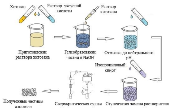
Рис.1. Схематичное изображение процесса получения хитозанового аэрогеля
