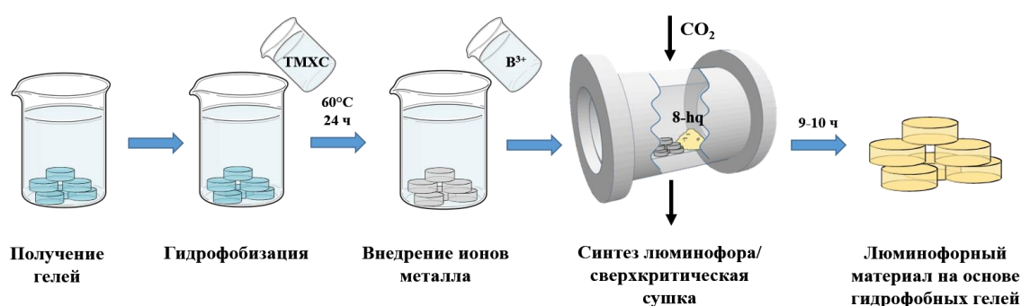
Рисунок 5. Схематичное описание процессов получения люминофорных материалов на основе гидрофобных аэрогелей
